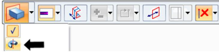
O indicador de extrusão se converte em um indicador de revolução.
