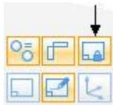
Faces planares que são coplanares a um plano de referência de base são bloqueados para este plano de base. Faces cilíndricas que sejam coaxiais a um eixo de sistema global de base são bloqueadas para este eixo global. Esta configuração está ativada por padrão.
