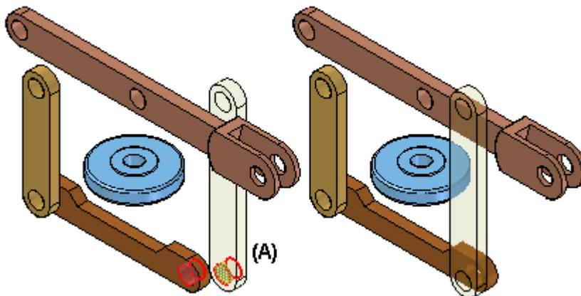
O comando Montar está estreitamente integrado com a opção de posicionamento FlashFit. Quando você clica no comando Montar, FlashFit é a opção padrão. Para mais informações sobre o FlashFit, consulte o tópico [Relações de Montagem](#).
