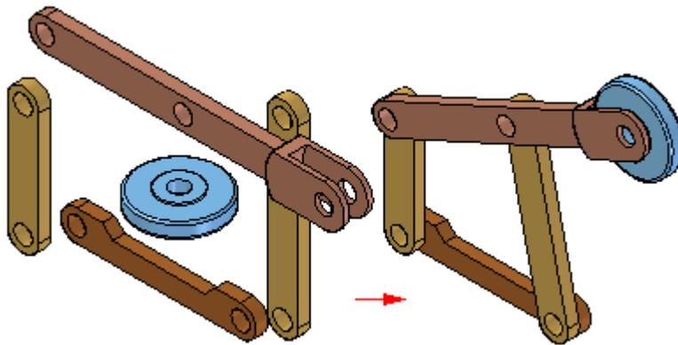
Primeiramente, arraste e solte o conjunto de peças na montagem. Depois clique no comando Montagem e aplique as relações entre uma peça e outras. Para posicionar uma peça diferente, clique no botão direito do mouse.
