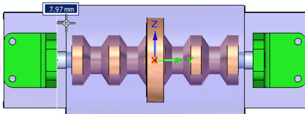
**Ativar no local a peça de plástico e criar a geometria entre as peças para cortar a peça.**
