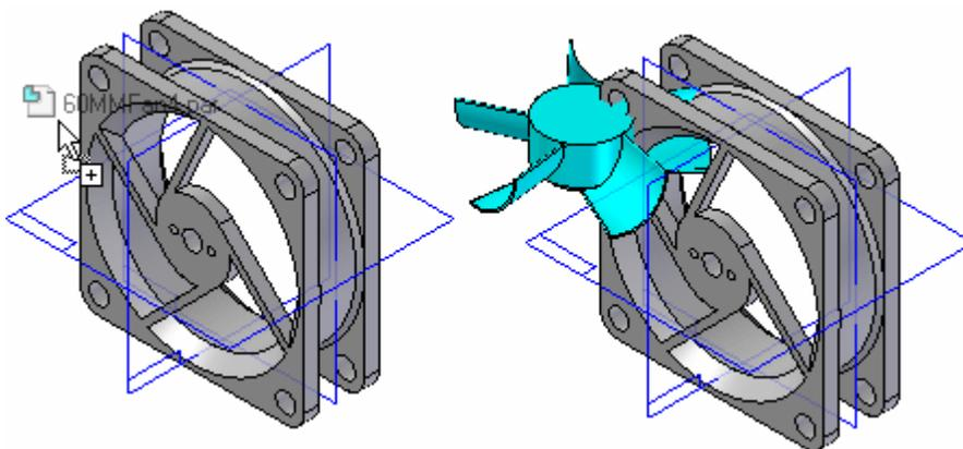
Se você trabalhar com a opção Não Criar Uma Nova Janela Durante o Posicionamento da Peça desmarcada, a peça será posicionada na montagem de tal forma que os planos de referência de base no documento da peça (A) coincidam com os planos de referência de base na montagem (B).
