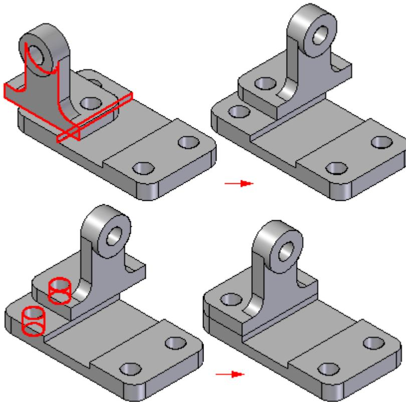
Peças adicionais podem ser posicionadas em relação a qualquer peça na montagem, ou mesmo em relação a mais de uma peça na montagem. Você também pode posicionar uma peça em com relação a um rascunho de montagem.
