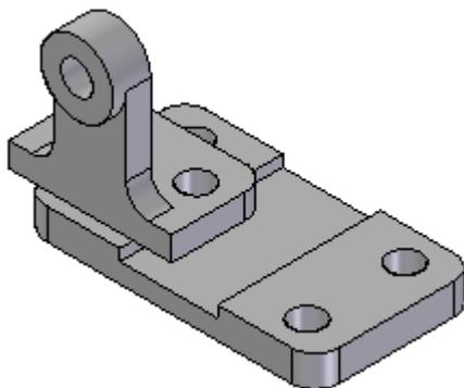
Conforme você aplica as relações de montagem restantes, o software posiciona e reorienta a peça na montagem.
