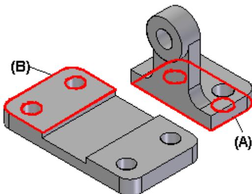
Depois que você aplicar a primeira relação da montagem, a nova peça é reposicionada na montagem.
