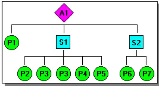
Você pode encontrar a peça P5 visualizando a montagem no painel superior do PathFinder, conforme mostrado na próxima ilustração. Pelo fato de a P5 estar entalhada sob a submontagem S1, você teria que abrir ou ativar no local a submontagem S1 a fim de visualizar, modificar ou remover quaisquer relações que controle a peça P5.
