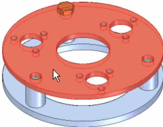
Em seguida, você deve selecionar o recurso padrão na peça ou rascunho de montagem. A peça que você usa como referência padrão não tem que ser a peça na qual você posicionou os componentes originais. Você pode selecionar recursos padrão que foram construídos com os seguintes comandos:
