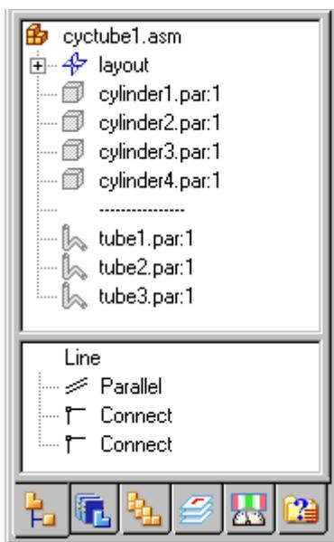
Observe a linha tracejada separando o cylinder4.par e o tube1.par. Esta linha tracejada indica que as peças abaixo da linha são peças direcionadas
