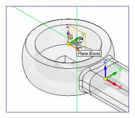
Clique com o botão direito e a ferramenta QuickPick será exibida. Posicione o cursor sobre a entrada do QuickPick que destaca o plano XY principal, como mostrado, depois clique para selecioná-la.
