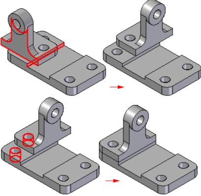
Peças adicionais podem ser posicionadas com relação a qualquer peça na montagem ou mesmo em relação a mais de uma peça na montagem. Você pode também posicionar uma peça com relação a um rascunho de montagem.
