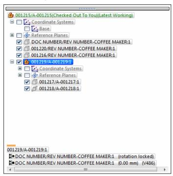
No ambiente Montagem, o PathFinder é dividido em dois painéis. O painel superior lista os componentes da montagem ativa e, uma estrutura de árvore de pastas. Os componentes listados podem incluir: peças, submontagens, layouts de montagem, planos de referência de montagem e rascunhos de montagem.
