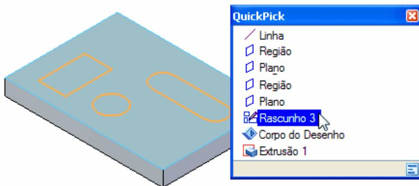
Depois, você pode usar a roda de direção para mover ou rotacionar o rascunho para uma nova posição no espaço.
