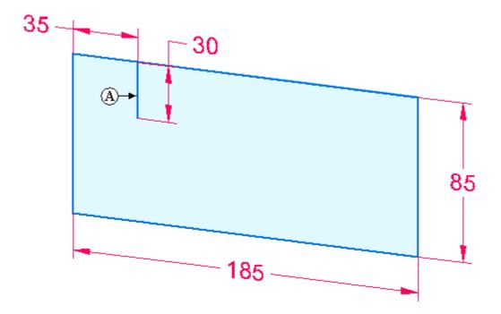
Na aba Início® grupo Desenho, selecione o comando Construção para converter a nova linha em um elemento de construção.
