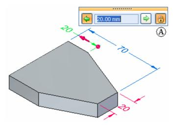
Por exemplo, você pode bloquear ambas as cotas de 20 mm antes de editar a cota de 60 mm. Em seguida, quando você editar a cota de 60 MM para 70 mm, as cotas de 20 mm não são alteradas.
