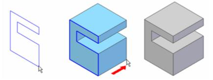
Para recursos em um corpo existente, a direção da extensão definida pela posição do cursor com relação à superfície planar ou plano do rascunho determina se você cria uma extrusão ou um recorte.
