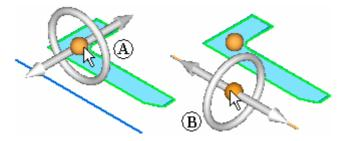
Você pode construir um recurso revolvido que seja igual ou menor que 360 graus usando as opções da barra de comando Revolver. Depois de definir as opções que deseja na barra de comando, você pode clicar no elemento de toro, no indicador revolver (A), para começar a construir o recurso. A forma do cursor se altera para retícula e uma representação dinâmica do recurso é exibida juntamente com uma caixa de entrada dinâmica, para que você possa digitar um valor angular para o recurso (B).
