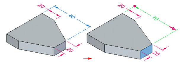
Cotas de PMI aparecem usando cores diferentes dependendo delas estarem bloqueadas ou desbloqueadas.
