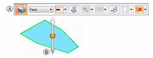
A barra de comando contém as opções necessárias para construir uma ampla variedade de recursos extrudados. Para iniciar o processo de construção de recursos, você posiciona o cursor sobre a seta no indicador de extrusão e clica em (A).
