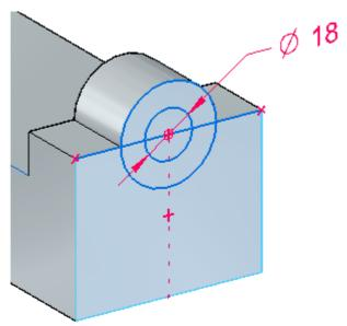
► Selecione e aceite as duas regiões limitadas pelo círculo de 18 mm de diâmetro. Use o QuickPick se necessário para selecionar as regiões. Construa um conjunto de seleção selecionando a primeira região e, mantendo pressionada a tecla Ctrl, selecione uma(s) região(ões) adicional(is).
