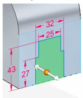
Clique no indicador de extrusão e defina a opção de extensão como Através de Todos na barra de comandos. Clique quando a direção da seta apontar para a peça.
