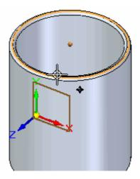
• Selecione o eixo X no sistema de coordenadas. Altere o valor da cota para 52 mm.
