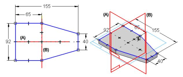
Orientar o rascunho para o recurso base simetricamente com respeito aos planos de referência básicos facilita a construção do resto do modelo, porque você pode também usar os planos de referência básicos para orientar simetricamente os recursos subsequentes.
