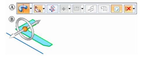
Para construir um recurso revolvido, mova o indicador revolver para um elemento de rascunho linear, aresta do modelo, ou para o centro de uma face cilíndrica que defina o eixo em relação ao qual deseja revolver o rascunho. No seguinte exemplo, o elemento de eixo está separado da região de rascunho que define o recorte transversal do recurso revolvido.
