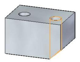
Se você mudar o tipo do furo para Finito, a profundidade do furo mudará para a profundidade original de 100 mm.
