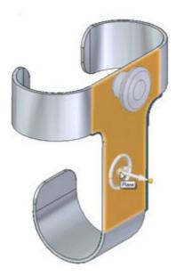
Uma vez colado, você pode usar a roda de direção para mover a geometria para a posição e orientação adequadas.
