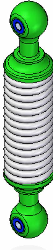
*shock\_top.asm* ainda está livre para mover-se ao longo do eixo dos cilindros. Você moverá esta peça e a mola ajustará o tamanho com base na posição dessa submontagem.
